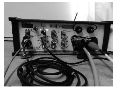
Figura 4. Digitalizador Obsidian de 24 bits.
