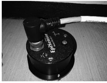
Figura 3. Un acelerómetro triaxial EpiSensor FBA ES-T
