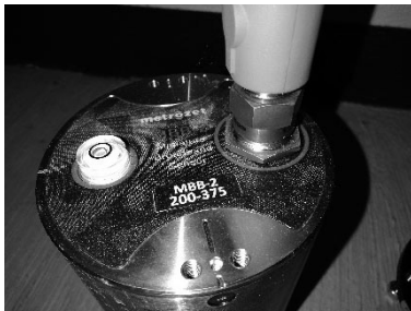
Figura 2. Sismómetro triaxial Mini Broad Band-2 Metrozet.
